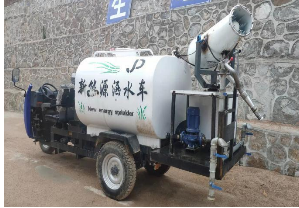
洒水车及雾炮装置
